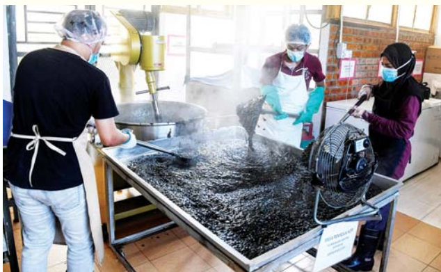
PROSES MENYEJUKKAN KOPI... Mohd Mustakim Mohd Kasturi (tengah) melakukan proses menyejukan kopi yang telah diadun dengan bahan seperti karamel dan mentega sebelum dikisar menjadi halus.
